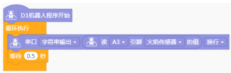
图 7-14 串口监视器显示火焰传感器的输入值的程序
