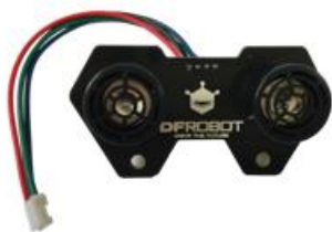
图 9-3 URM10 超声波传感器
