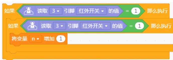
图 18-5 避免小球在最低点时红外避障传感器重复检测程序
