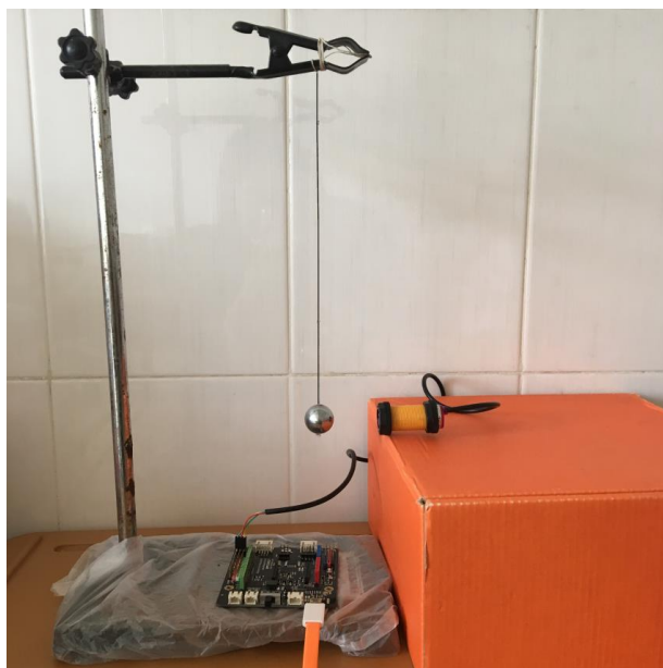
图 18-2 Arduino 与单摆实验装置
