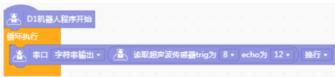
图 9-5 超声波测距显示距离值
