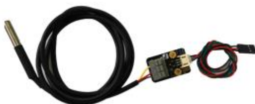
图 15-4 防水温度传感器与转接器的连接图
