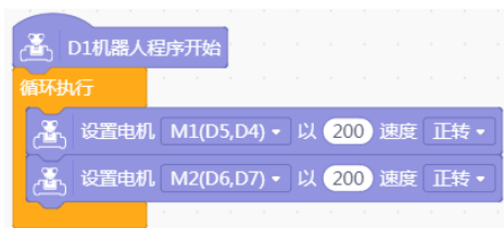
图 11-8 用电机模块控制小车前进
