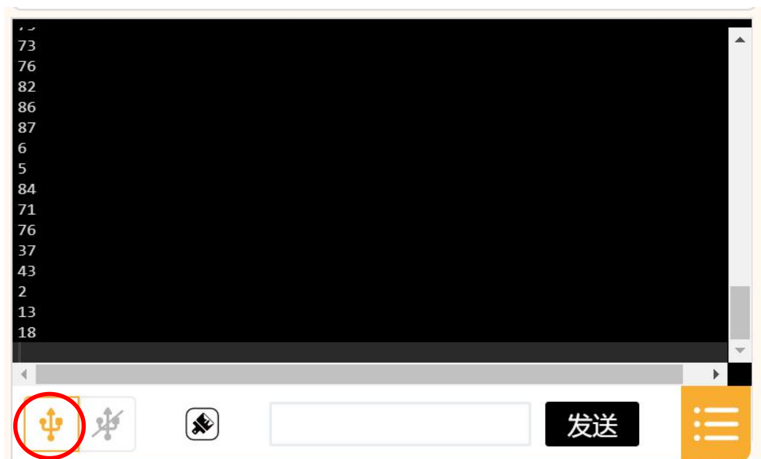
图 5.5 单击打开串口按钮,就能看到光线传感器传回来的数值
