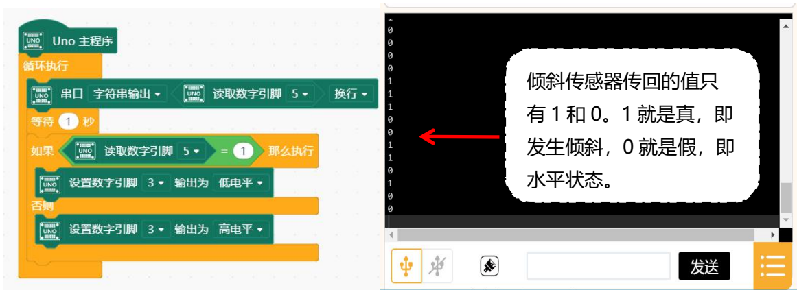
图 6.4 倾斜检测灯参考程序
