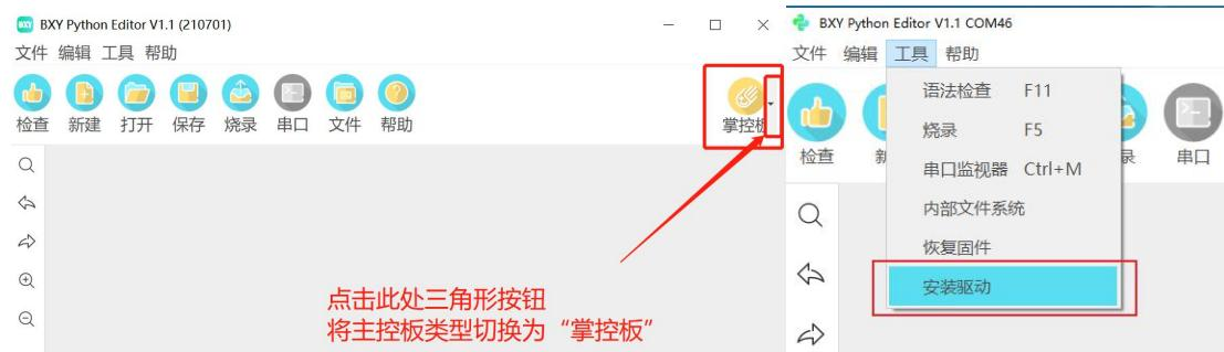
注 2：如果掌控板中没有固件，则会提示烧录固件，也可以手动在“工具”菜单下选择“恢复固件”。
