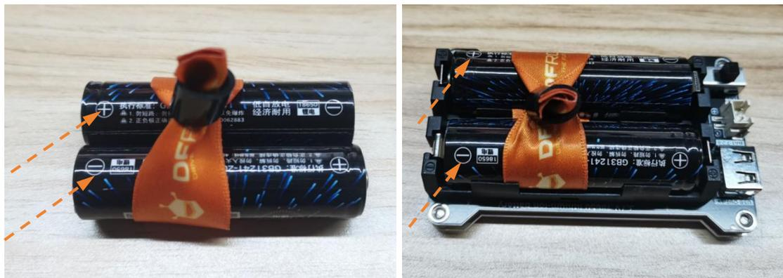
在电池盒上连接上电源线，然后将电池盒放入小车底板正中间，用力向下压将魔术贴粘紧。
