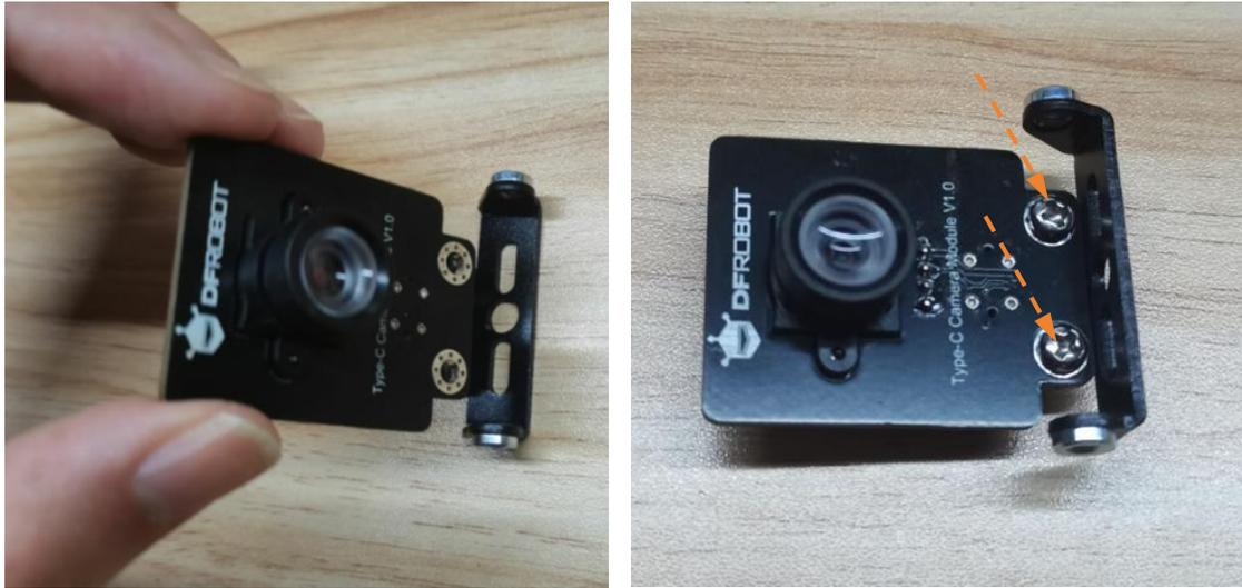
使用 M3\*6 盘头螺丝，将装好摄像头的支架和增高支架进行固定，注意图中摄像头支架和增高支架的位置。然后，将 type-c 连接线连接在摄像头上。
