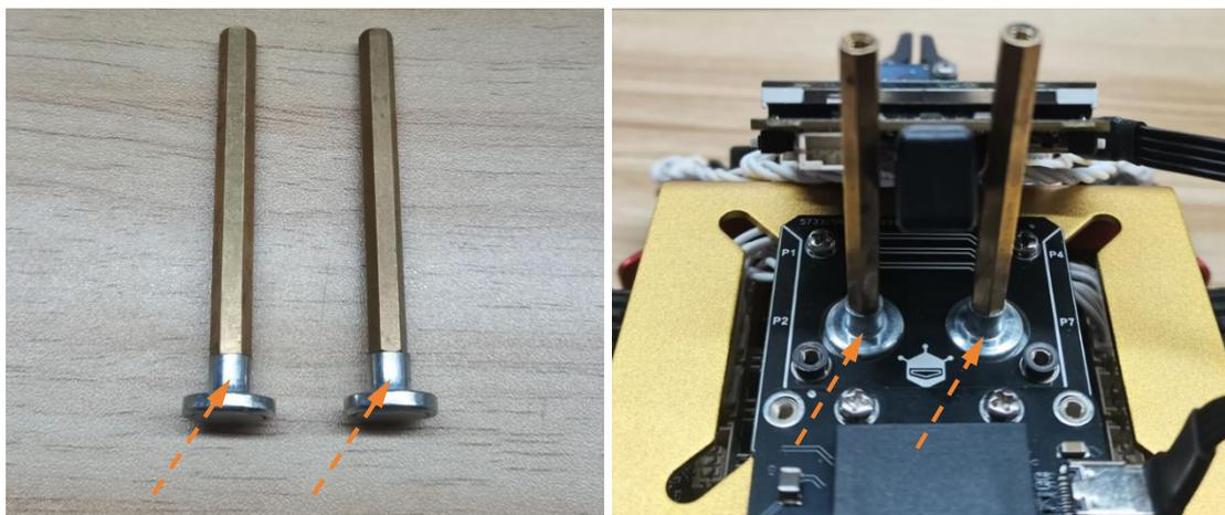
使用 M3\*6 盘头螺丝，将组装好的摄像头支架安装在铜柱上。然后，使用 type-c 连接线将摄像头和 USB 音频模块进行连接。
