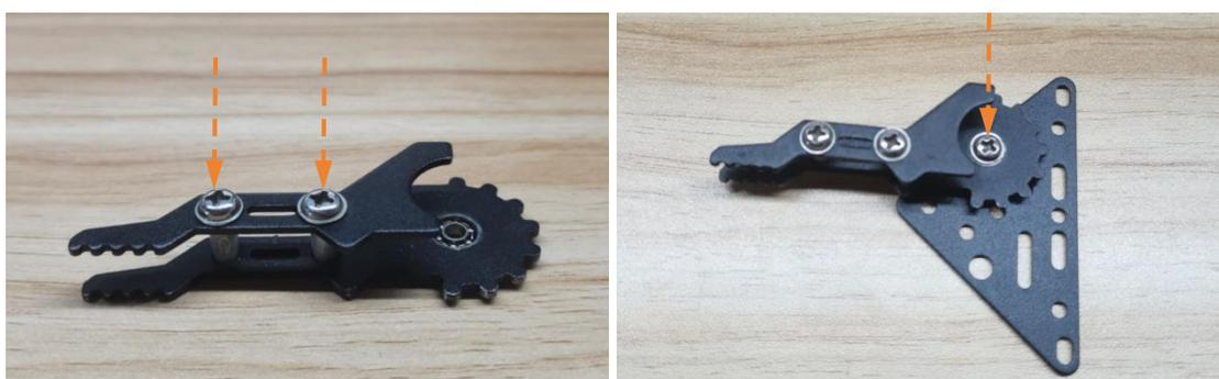
将带有机械臂的机械爪底板，安装在机械爪面板上，注意机械爪的方向。
