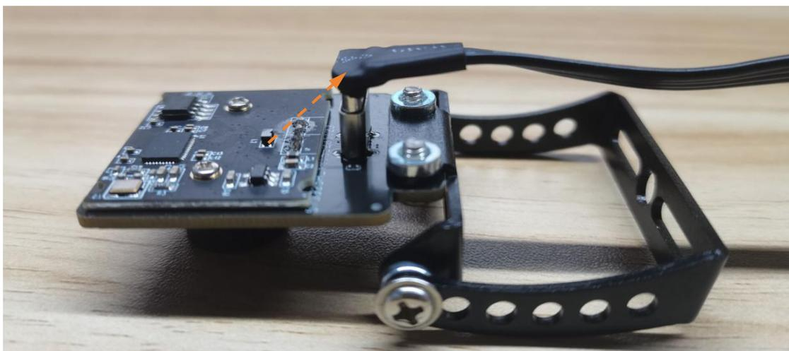
将铜柱和 M3 磁吸螺母进行组装，组装完成后，将铜柱放在安装扩展板的磁吸孔中。
