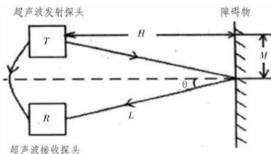
超声波发射器向某一方向发射超声波，超声波在空气中传播，途中碰到障碍物就立即返回来，超声波接收器收到反射波。通过转换计算，就得到了距离 H。
