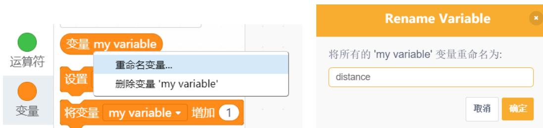
在行车安全仪项目中，我们需要实时监测超声波传感器测量的距离值，将超声波传感器测量的距离值赋值给变量“distance”。
