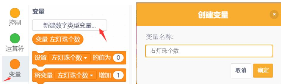
左侧灯带（P5）的灯珠的个数的变化，就需要控制变量“左灯珠个数”来控制了；右侧灯带（P11）的灯珠的个数的变化，就需要控制变量“右灯珠个数”来控制了。
