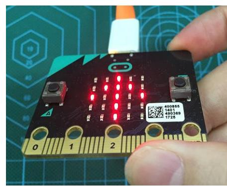
当检测到 Micro:bit 的徽标朝下时，用“向上箭头”显示出来当前的状态，发出控制另外一个 Max:bot 向前的指令。
