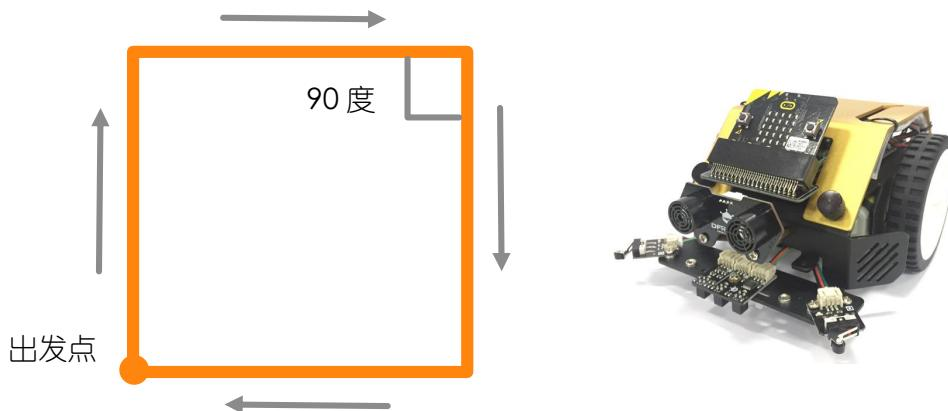
小车直行的程序在前面已经介绍过了，大家有没有写出来呢？根据差速转向原理，要想让小车原地顺时针转过 90 度角，需要小车**右轮不转，左轮转动**，小车实现转弯。
