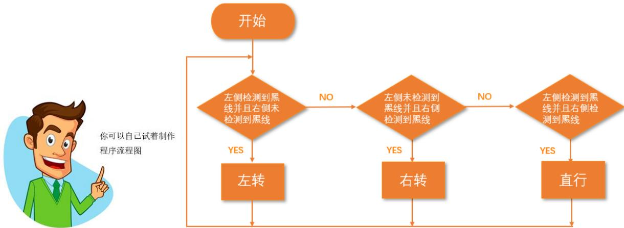
(5) 根据流程图完善程序，保存项目，命名为“循轨蹈矩”，将程序下载到 Max:bot 小车，小车就可以沿着轨迹行驶啦！
