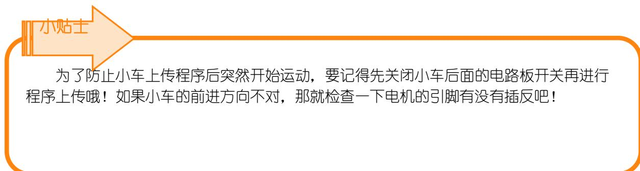
为了防止小车上传程序后突然开始运动，要记得先关闭小车后面的电路板开关再进行程序上传哦！如果小车的前进方向不对，那就检查一下电机的引脚有没有插反吧！
