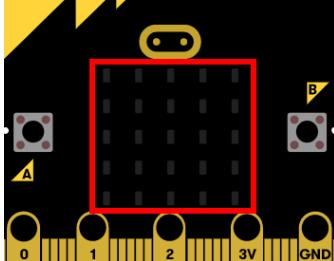
A photograph of a Micro:bit board. A red rectangle highlights the central 8x8 pixel matrix area, which is the light sensor component. | Micro:bit 的图案显示部分还可以感知光的强度值。具有感光的元件，可以直接将光的强度转化为电信号输出。 |
