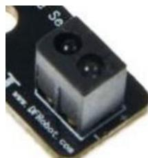
其中一个红外发射传感器发射出红外线，另外一个接收红外线。巡线传感器工作原理与超声波传感器类似，但其得到的结果并不会转化成距离，只能判断有没有障碍物。
