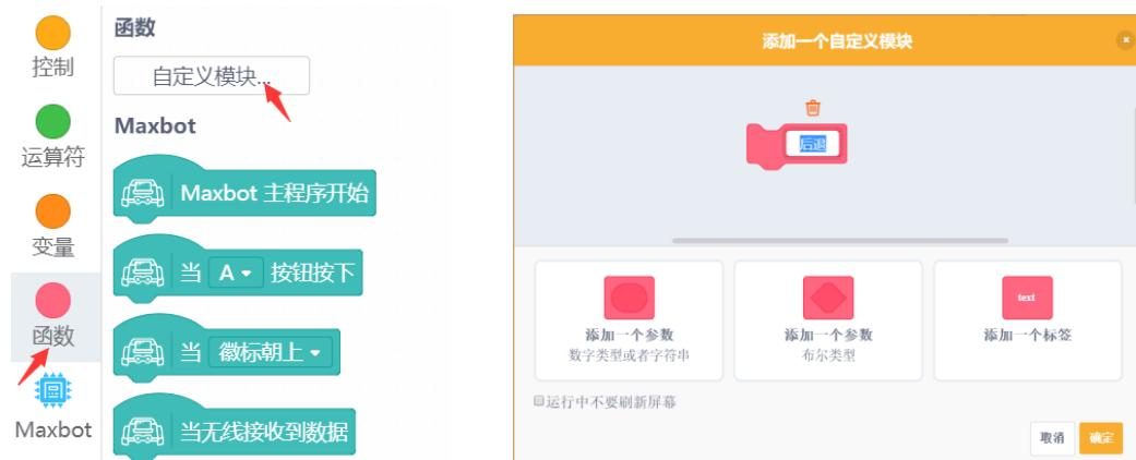
定义“后退”和“左转”两个函数。调用函数时只需将定义后的子函数模块拖入主程序中适当位置即可。
