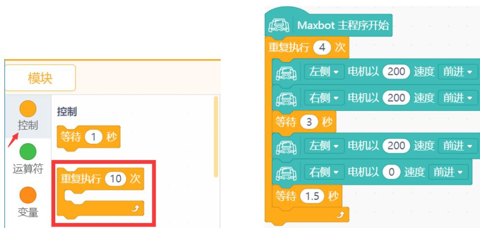
(5) 在重复执行模块外加入使左轮右轮停止的模块指令。
