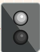
巡线传感器帮助机器人进行白线或者黑线的跟踪,可以检测白背景中的黑线,也可以检测黑背景中的白线。
