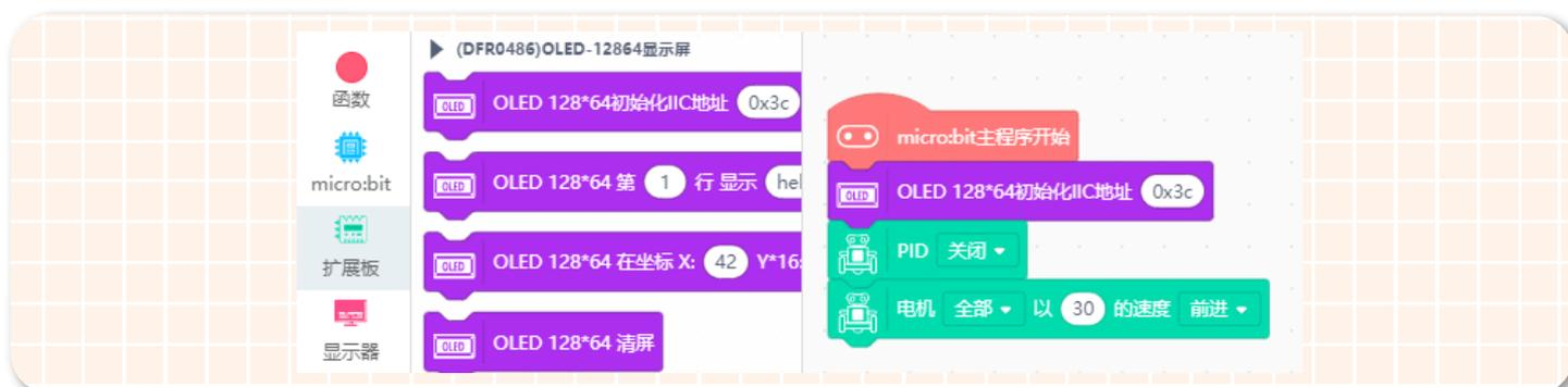
3、因为需要 OLED 显示屏上实时的显示数据,所以将 OLED 数字显示模块放入循环执行模块中。如下图所示。
