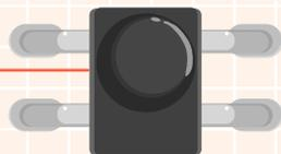
将红外遥控器发来的红外光信号转换成电信号。
