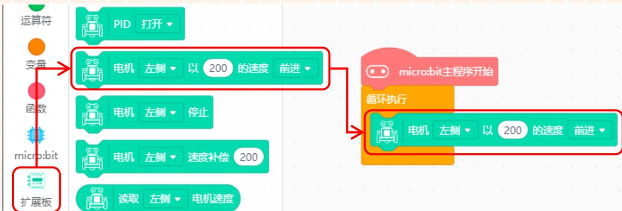
3、将电机模块中的“左侧”更改为“全部”,这样麦昆 Plus 左右两侧的轮子就能以 200 的速度前进。如下图所示。
