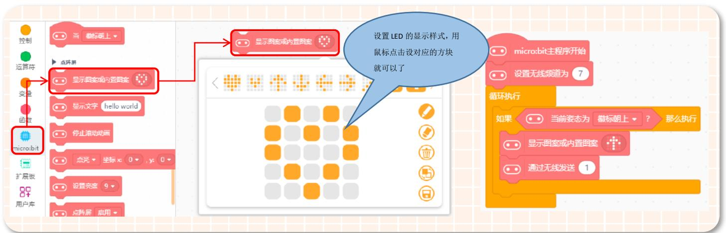
3. micro:bit 向下、向左、向右转动的程序实现是一样的, 只需要将无线发送数字改成不同的就可以了。控制端的完整程序如下:
