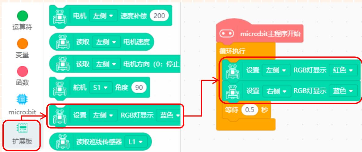
因为警车的警灯是交替显示的,所以接下来我们需要将麦昆 Plus 的左侧 RGB 灯显示蓝色,右侧的 RGB 灯显示红色。如下图所示。
