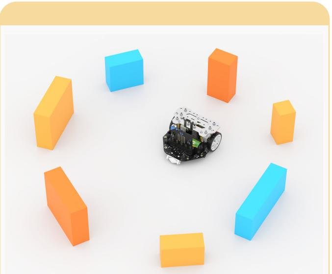
小车自动避障行走，当遇到障碍物时，小车先后退再转向，自动避开障碍物。
