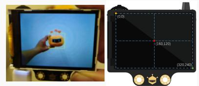
方框参数的“X中心”、“Y中心”是指识别框的中心点在屏幕坐标系中的位置。
