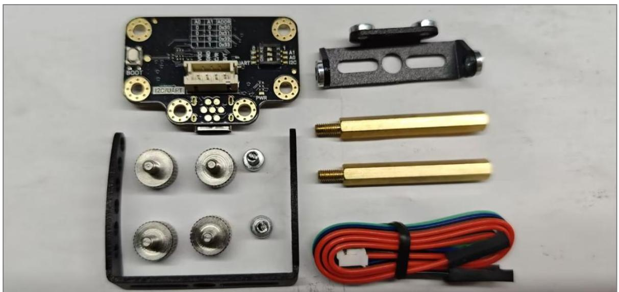
使用 M3 螺丝将矩阵激光测距模块固定在专用支架上，需要注意一下矩阵激光测距模块的方向。
