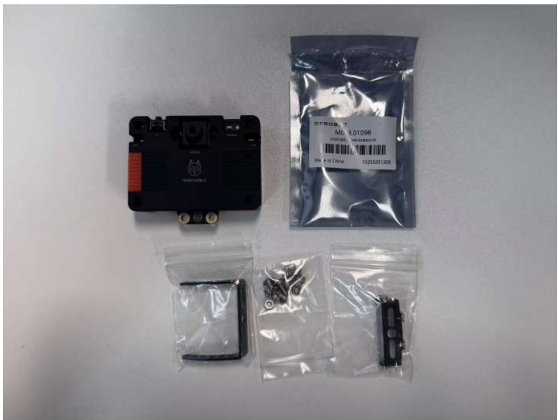
打开螺丝包可以看到，从左至右分别为 U 形支架，螺丝螺母包以及一字型支架
